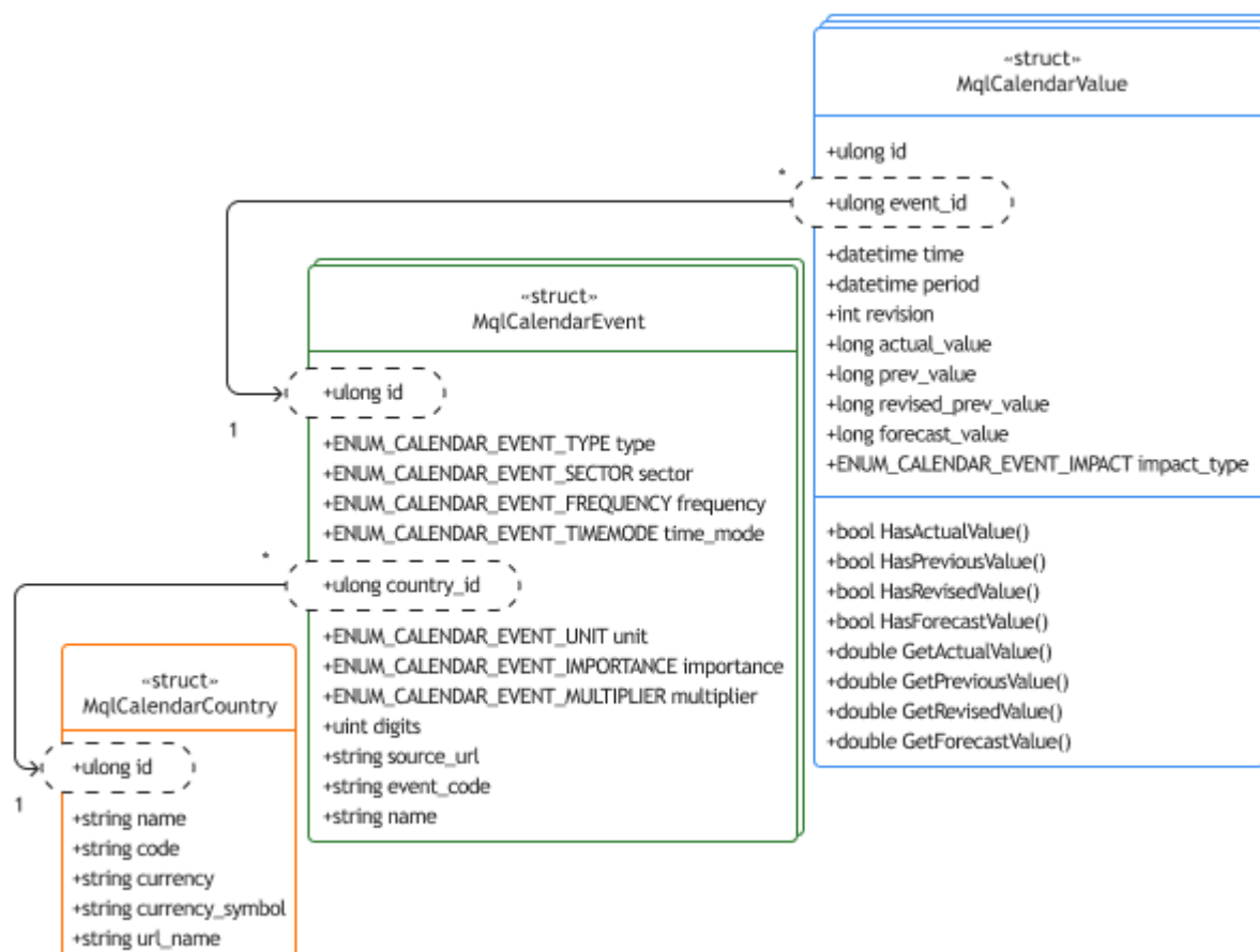
Diagrama de enlaces entre estructuras por campos con identificadores
